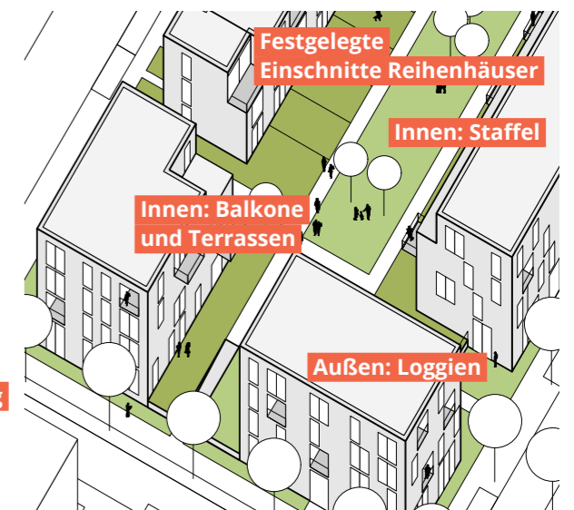
Schema 2 Schematische Darstellung der Festlegungen für die Kubaturen; exemplarisch verortet in der Axonometrie BF 10 und 11
