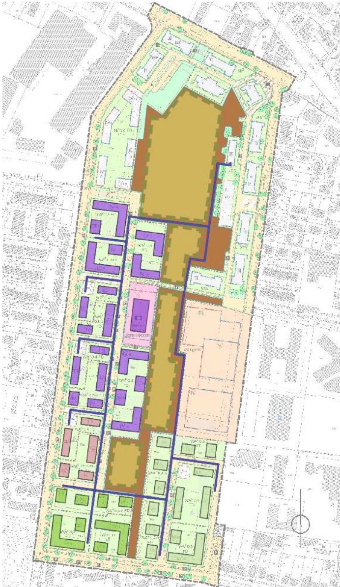
Abbildung 5 Abgrenzung der Flächen für die Erdwärmekollektorfelder
